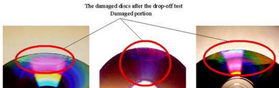
MAM (MITSUI) jako jedyny, stosuje technologię rotacyjnego, odśrodkowego rozprowadzania płynnej substancji klejącej po całej powierzchni dysku, utwardzanej promieniowaniem UV. Inni producenci używają substancji klejących wrażliwych na ciepło i nakładają je tylko na obszar danych. Gdy siła klejenia jest niewystarczająca, to podczas upadku dysk może ulec mikropęknięciom i rozklejeniu.
